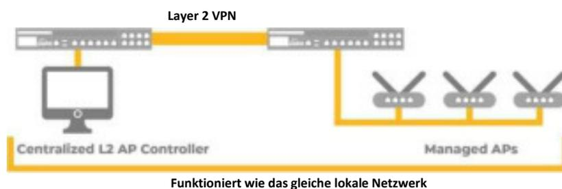
Durch Bildung eines SpeedFusion Layer 2-VPN können Geräte von verschiedenen Standorten so betrieben werden, als würden sie sich in demselben lokalen Netzwerk befinden. Diese Technologie ist nützlich, um Geräte wie Drucker und Accesspoints aus der Ferne zu betreiben, Netzwerkressourcen wie NAS-Laufwerke gemeinsam zu nutzen und die Server-zu-Server-Kommunikation zu vereinfachen.
